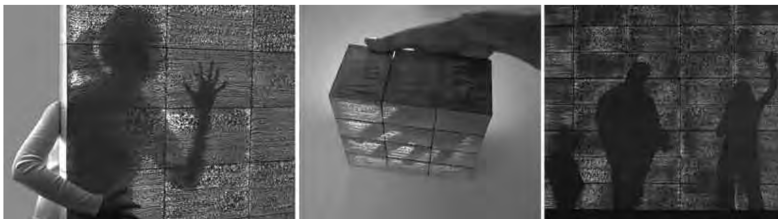
5) LiTraCon (Ligh-Transmitting Concrete), materia dall'aspetto e dalla compattezza del calcestruzzo, ma che lascia passare la luce e con essa l'immagine.
